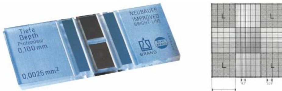
Slika 5. Prikaz Neuebaureove komorice za brojanje stanica. (Anonymus 2, 2021)
