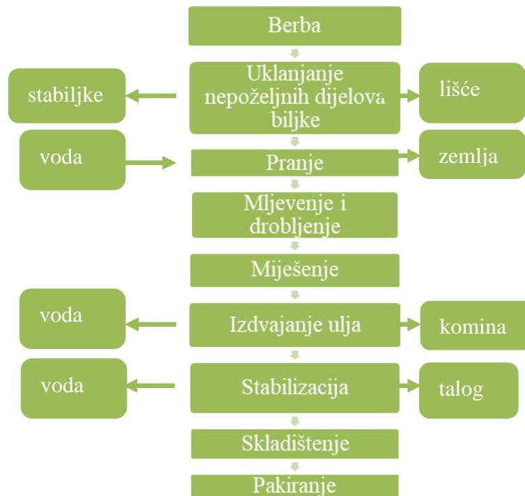
Slika 5. Opća tehnološka shema proizvodnje maslinovog ulja
