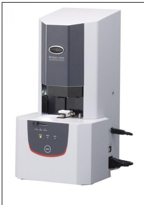
**Slika 9.** BioSpec Nano-drop spektrofotometar (Shimadzu Biotech)
