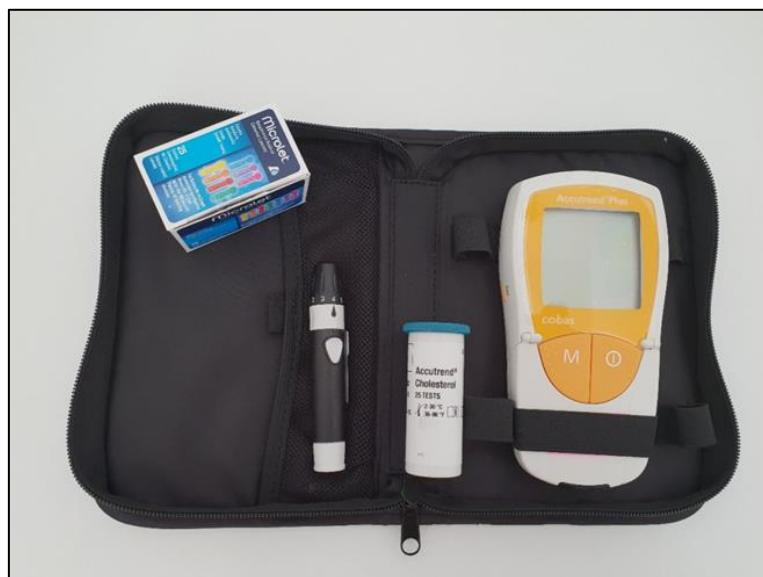
**Slika 7.** Uredaj za mjerenje glukoze i kolesterola iz kapilarne krvi *Accutrend® Plus System* (*Roche Diagnostic USA*) (vlastita fotografija)
