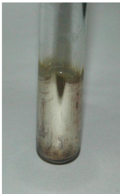
Slika 6. 11. Nastanak srebrnog zrcala (Tollensova reakcija). Izvor: autori.
