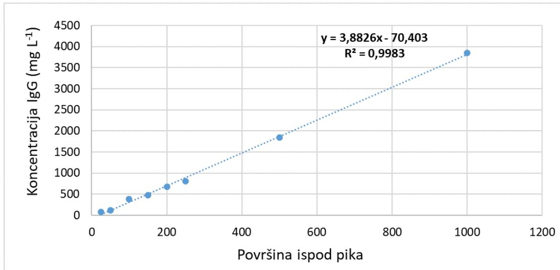
Slika 7. Baždarni dijagram za HPLC određivanje koncentracije IgG
