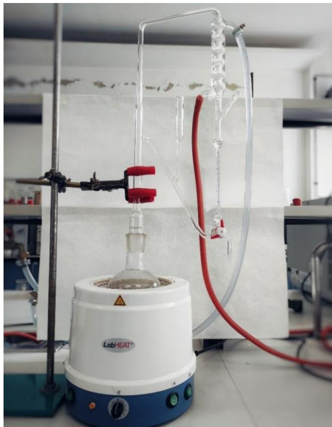
**Slika 8.** Aparatura po Clevengeru (vlastita fotografija)
