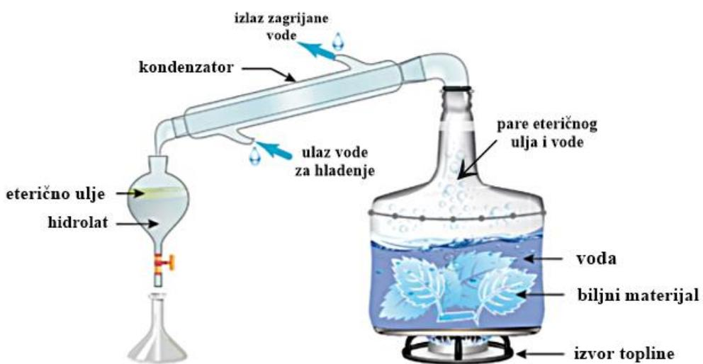
**Slika 6.** Shematski prikaz vodene destilacije (prema Roohinejad i sur., 2017 )
