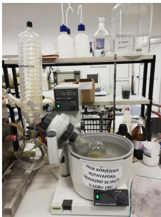
Slika 6. Rotavapor (B-490, BÜCH, Flawil, Švicarska) (vlastita fotografija)
