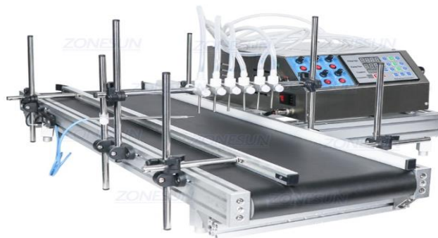
Slika 21. Automatska punilica (Zonesun, 2022)
