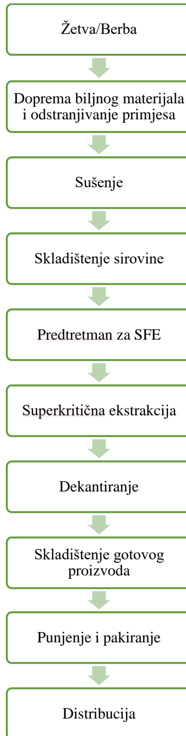
Slika 9. Blok-shema tehnološkog procesa za dobivanje superkričnih ekstrakata iz sjemenki komorača, plodova mirte te plodova pasjeg trna (vlastita shema)
