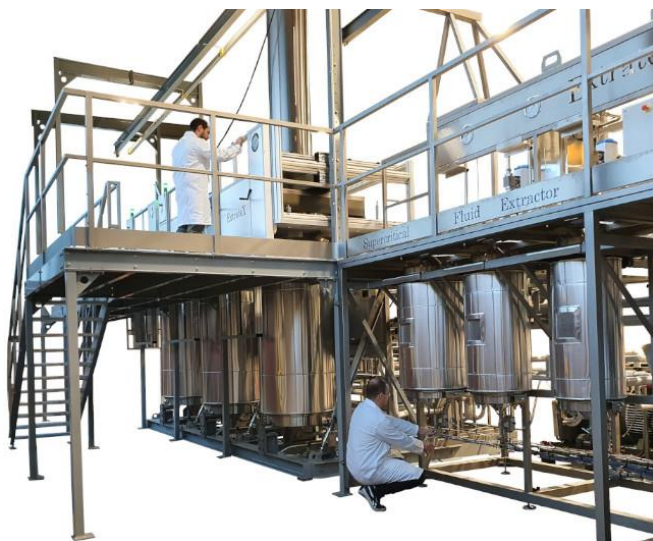
Slika 19. Uređaj za superkritičnu ekstrakciju (Extratex, 2022)
