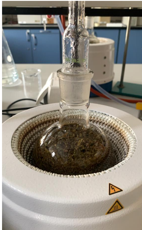
Slika 11. Okrugla tikvica sa suspenzijom u aparaturi po Clevenger-u (vlastita fotografija)
