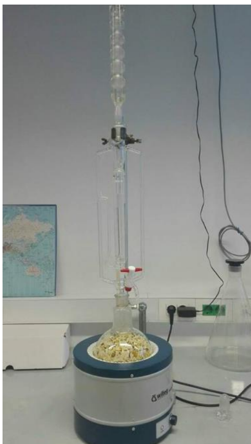
Slika 1. Aparatura po Clevenger-u (Tutek, 2017)
