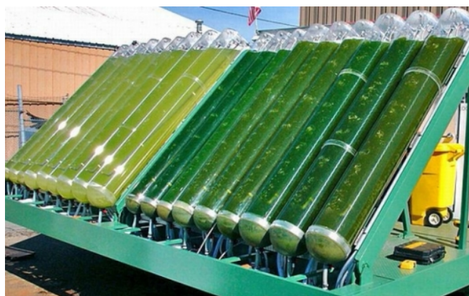
Slika 1. Fotobioreaktorski sustavi za uzgoj mikroalgi [18]
