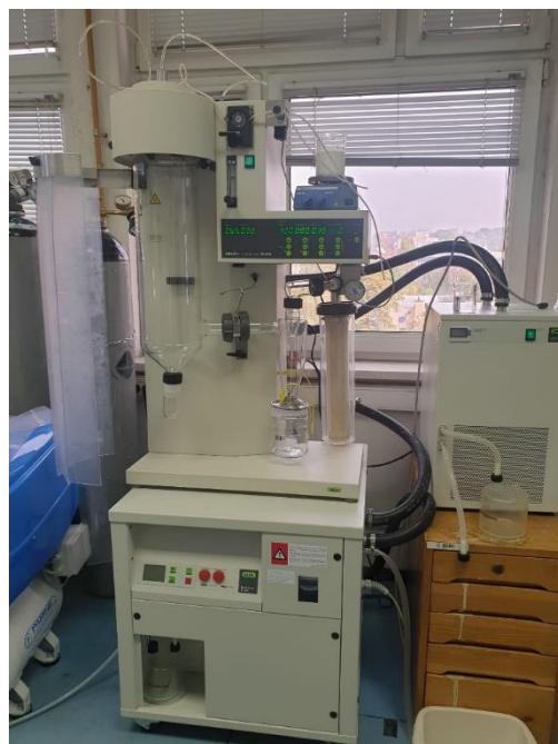
**Slika 6.** Mini Spray Dryer B-290 (vlastita fotografija)
