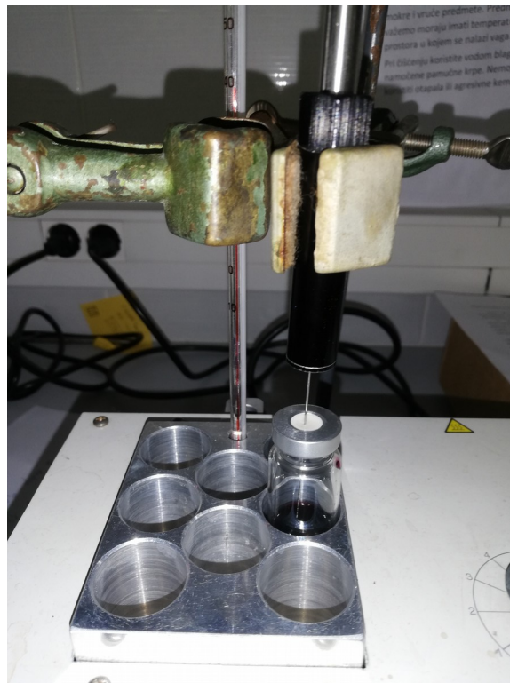
Slika 6. Uvećani prikaz adsorpcije na SPME vlakno (vlastita fotografija)
