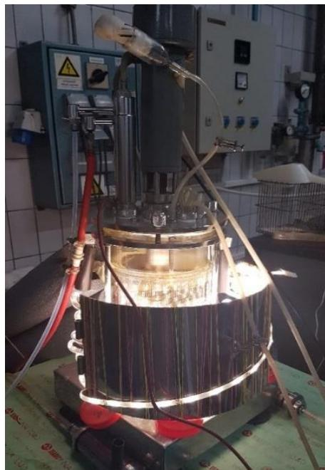
**Slika 13.** Fotobioreaktor za uzgoj mikroalgi (vlastita fotografija)
