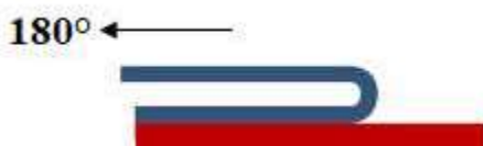
Slika 2. Povlačenje samoljepljive trake pod kutom od 180° (Morris 2017)
