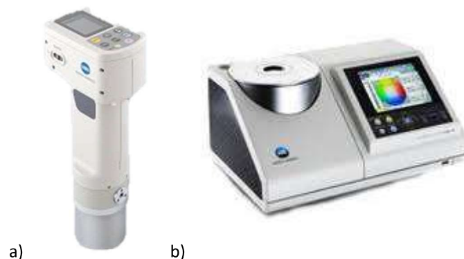
Slika 1. Prijenosni (a) i stolni (b) kolorimetar (preuzeto od Anonimus 1)
