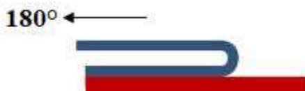
Slika 2. Povlačenje samoljepljive trake pod kutom od 180° (Morris 2017)
