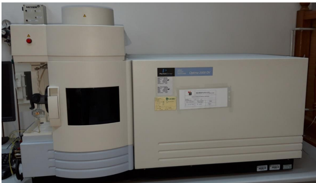
Slika 2. Spektrometar optičke emisije induktivno spregnute plazme u laboratoriju HAPIH-CVVU. Vlastita fotografija.
