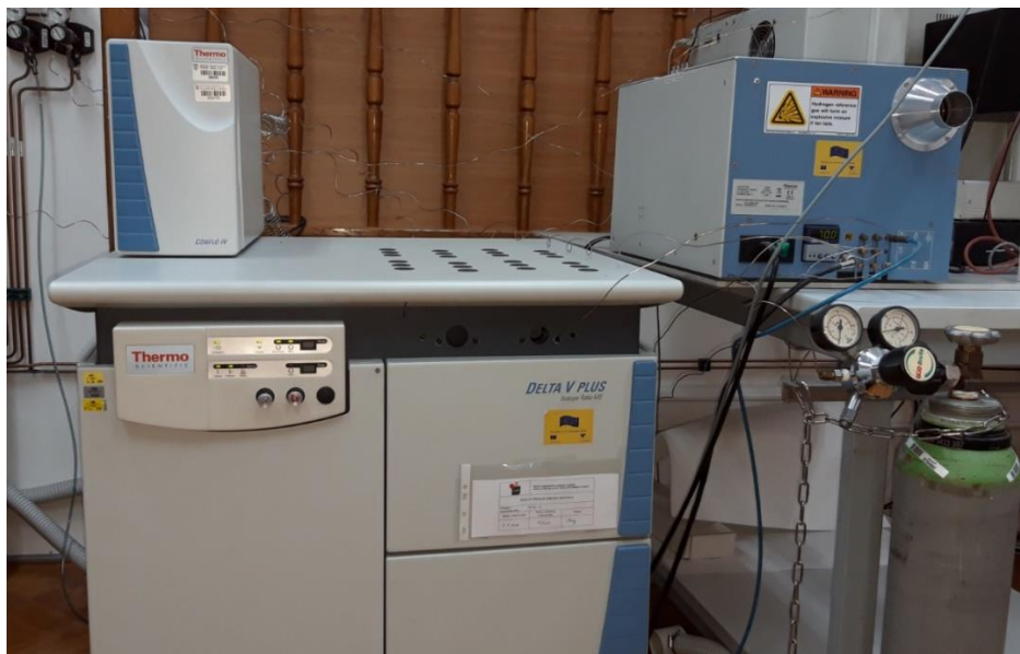
Slika 5. Spektrometar masa IRMS u laboratoriju HAPIH-CVVU. Detektor Delta V Plus (lijevo dolje) i periferna jedinica za pripremu i uvođenje plina (desno gore). Vlastita fotografija.
