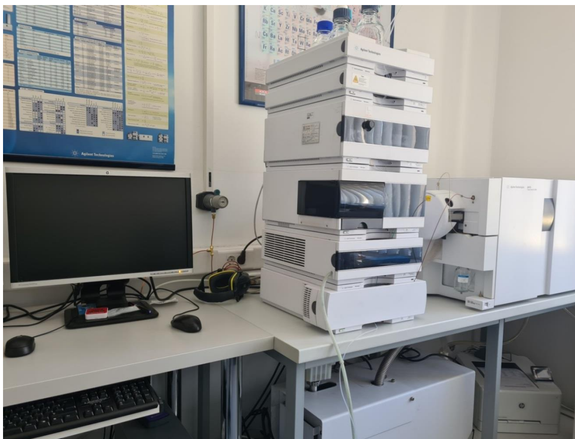
Slika 19. Tekućinski kromatograf sa tandemskom spektrometrijom masa (LC-MS/MS) Agilent Technologies (vlastita fotografija)
