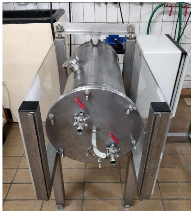
Slika 7. Horizontalni rotirajući cijevni bioreaktor (HRCB).
