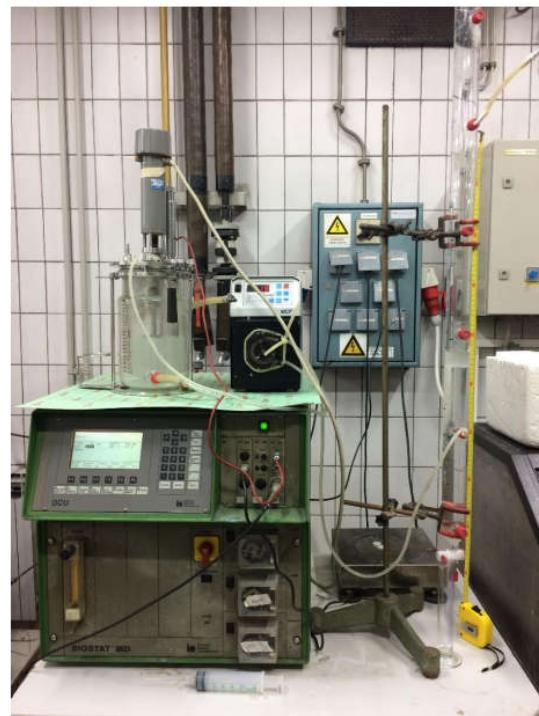
**Slika 8.** Uređaj za ekstrakciju etanola iz hranjive podloge.
