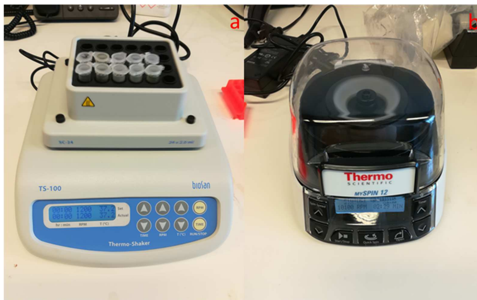
Slika 32. Simuliranje dvofaznog in vitro modela probave: stavljanje uzoraka na probavu u inkubator (a) i centrifugiranje uzoraka (b) (vlastita fotografija).
