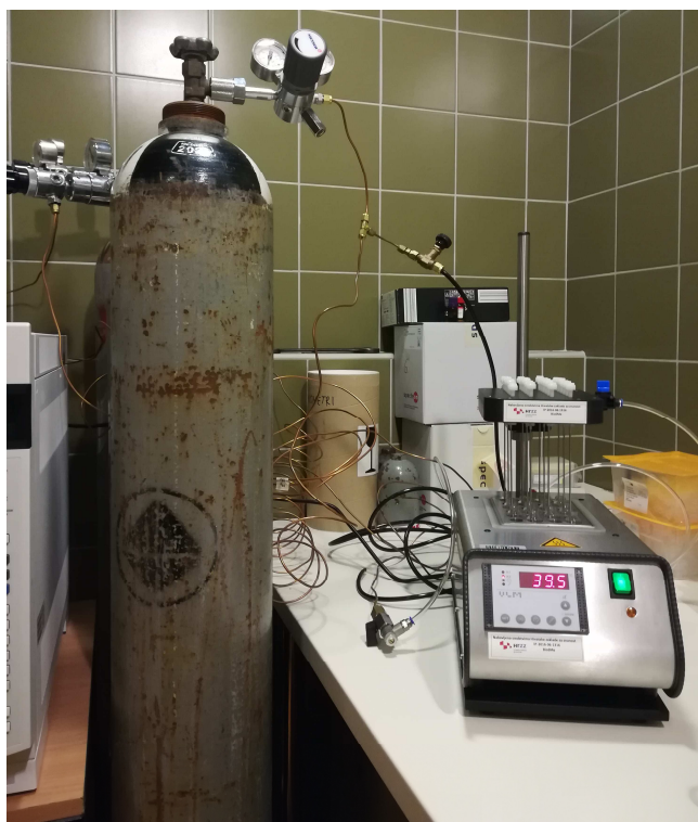
Slika 25. Prikaz uređaja za uparavanje eteričnih ulja i ekstrakata inertnim dušikom (vlastita fotografija).
