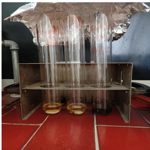
Slika 7. Kivete s uzorcima u bloku za spaljivanje nakon procesa spaljivanja (vlastita slika)
