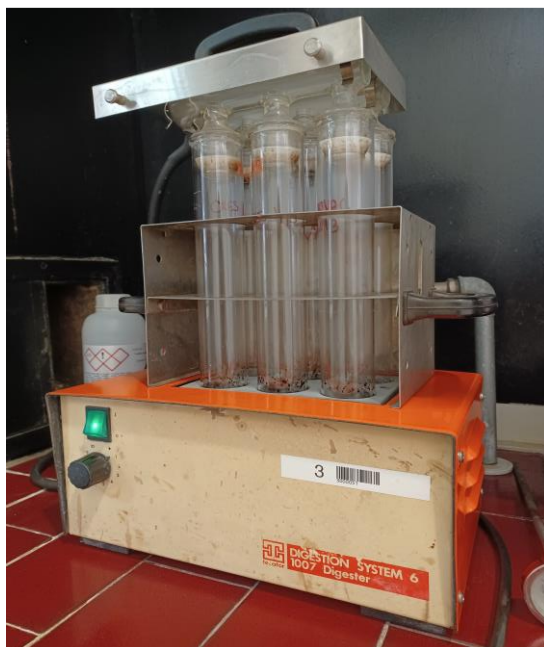
Slika 6. Blok za spaljivanje sa kivetama u digestoru (vlastita slika)
