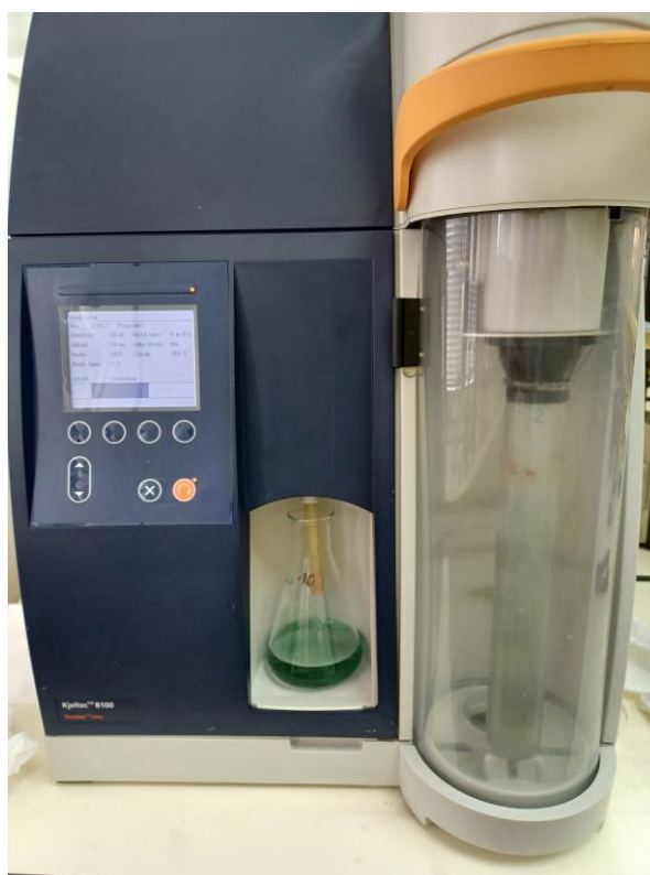
Slika 8. Kjeltec sustav (vlastita slika)
