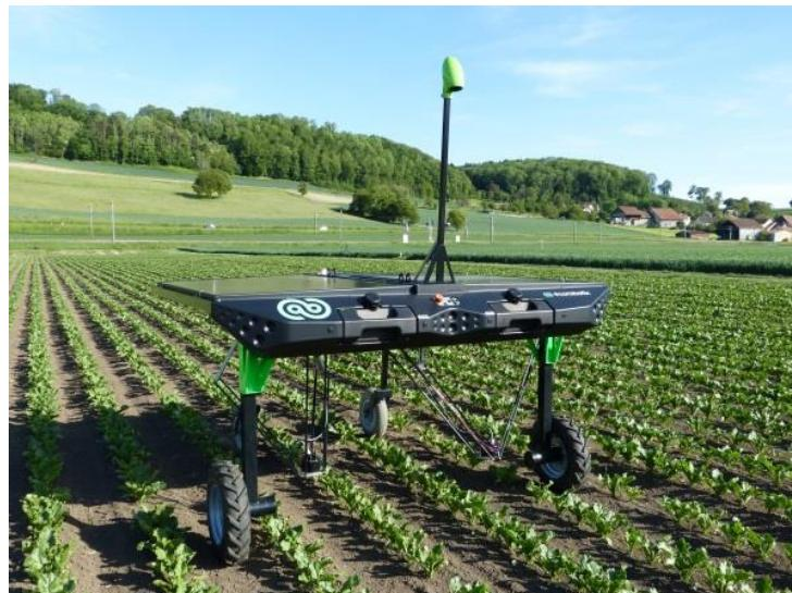
**Slika 11.** Autonomni robot za uklanjanje korova (Anonymous 6)
