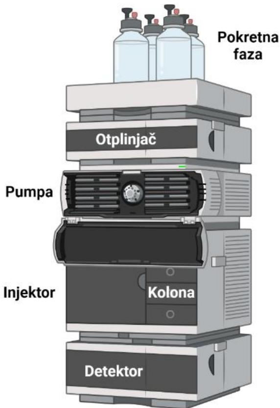
**Slika 2.** Shematski prikaz tekućinskog kromatografa. (Napravljeno pomoću BioRender.com)
