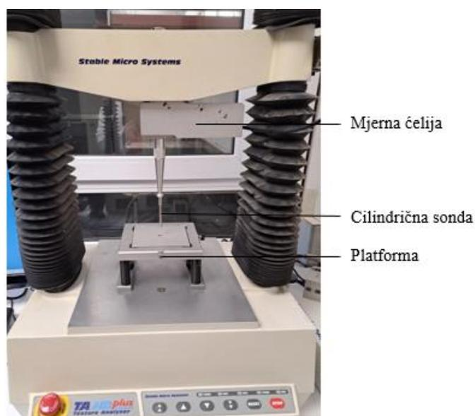
**Slika 8.** Teksturometar TA.HD.plus Texutre Analyser s cilindričnom sondom (*vlastita fotografija*)
