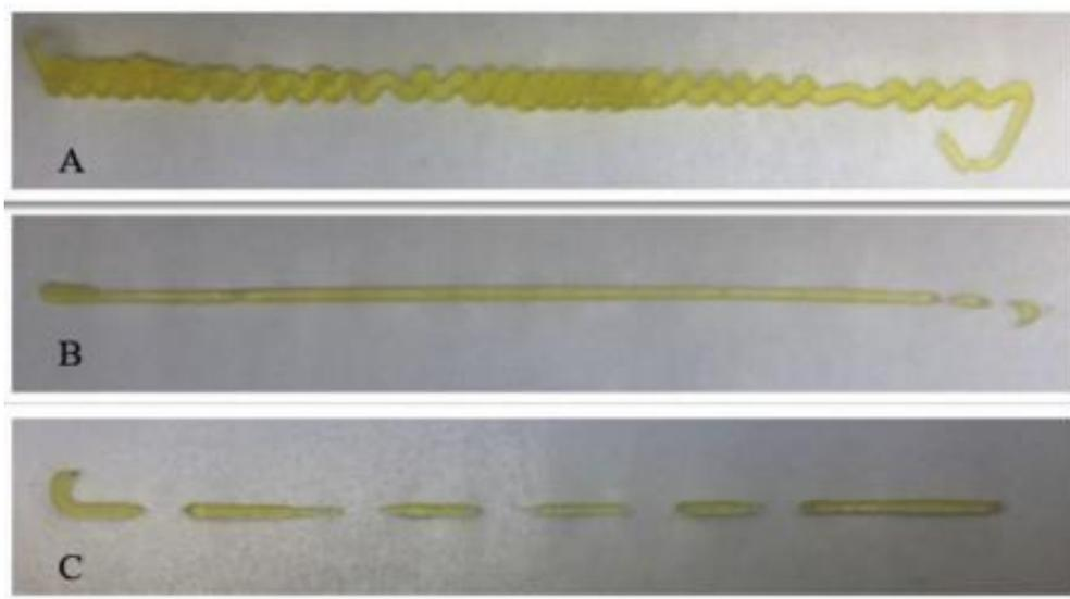
**Slika 3.** Utjecaj brzine ekstruzije materijala i brzine kretanja mlaznice na oblik linije (Yang i sur., 2017)
