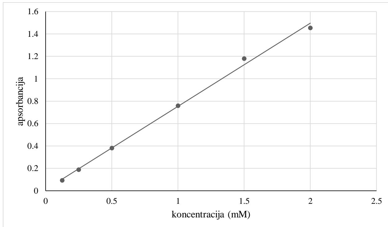
**Slika 7.** Baždarni dijagram željezovog sulfata za FRAP metodu
