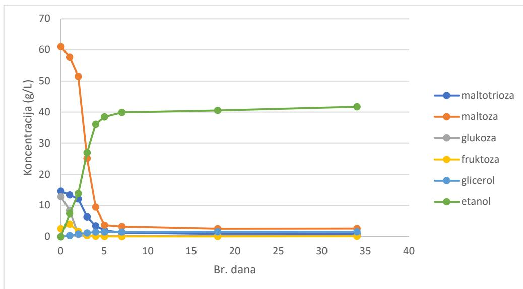
**Slika 6.** Promjene koncentracije fermentabilnih šećera i alkohola tijekom glavnog i naknadnog vrenja svjetlog lager piva dobivenog infuzijskim postupkom ukomljavanja.
