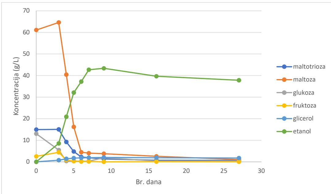
**Slika 8.** Promjena koncentracije fermentabilnih šećera i alkohola tijekom glavnog i naknadnog vrenja svjetlog lager piva dobivenog postupkom ukomljavanja dvostrukom dekokcijom
