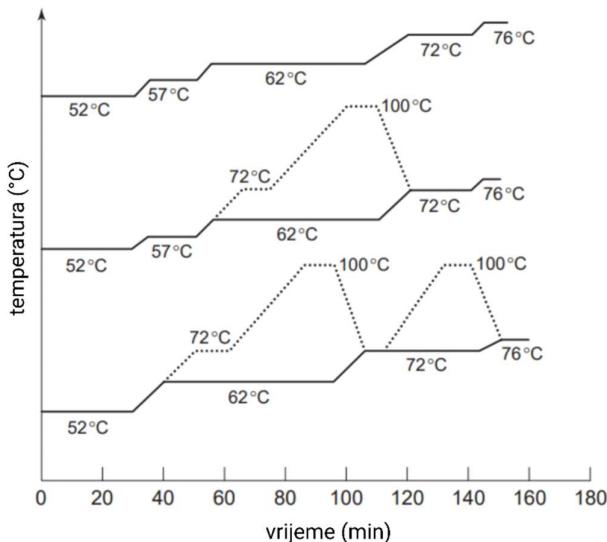
**Slika 5.** Usporedba režima infuzijskog ukomljavanja, dekokcijskog ukomljavanja s jednim i s dva odvarka za proizvodnju sladovine sličnog sadržaja ekstrakta ( prema Briggs i sur., 2004)
