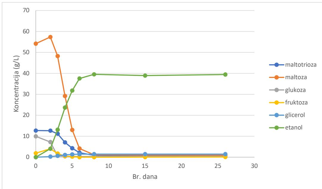
**Slika 7.** Promjena koncentracije fermentabilnih šećera i alkohola tijekom glavnog i naknadnog vrenja svjetlog lager piva dobivenog postupkom ukomljavanja jednostrukom dekokcijom.
