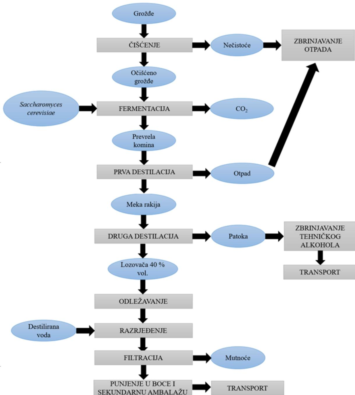
Slika 28. Blok shema procesa proizvodnje lozovače (vlastita slika)
