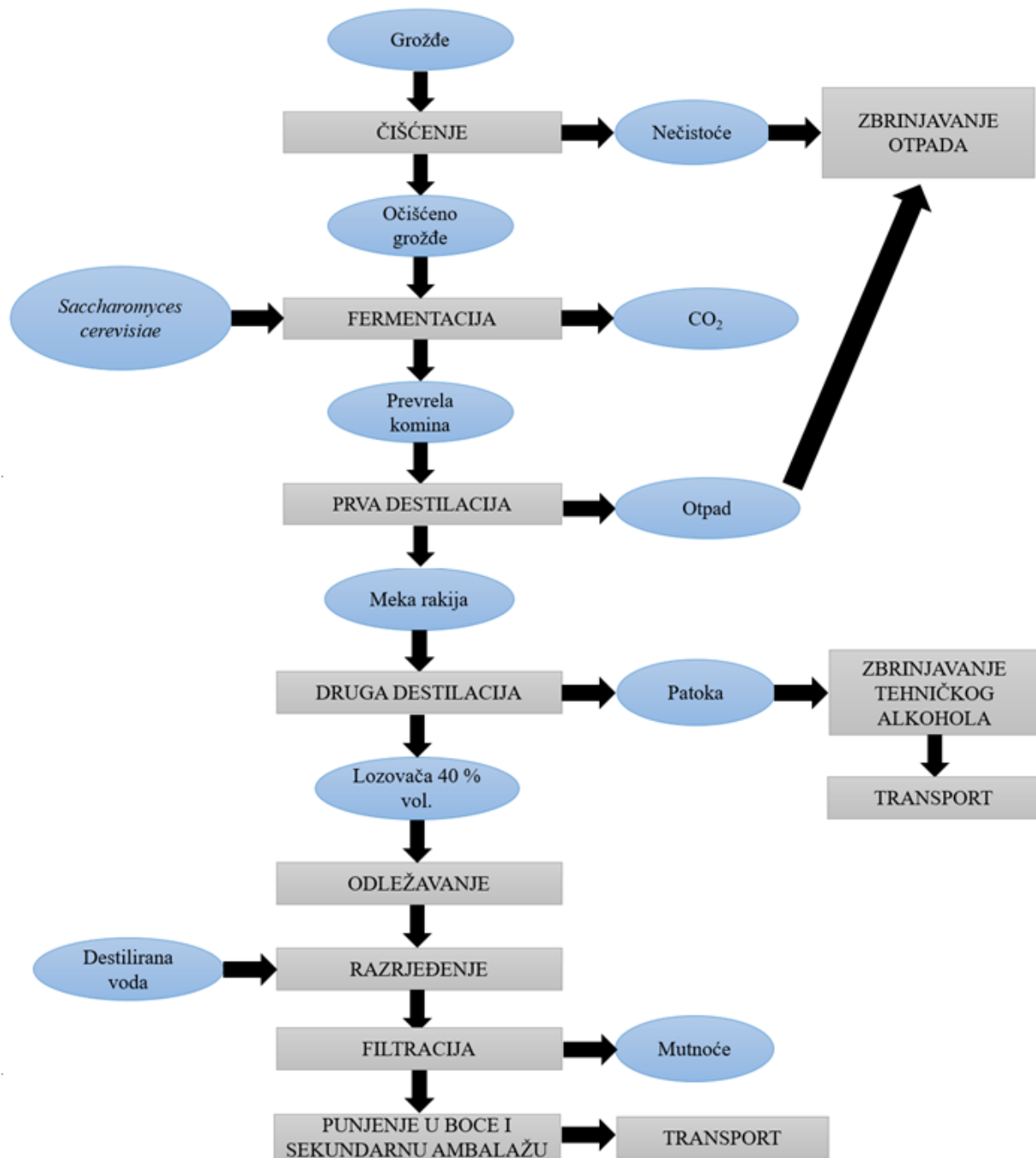
Slika 28. Blok shema procesa proizvodnje lozovače (vlastita slika)
