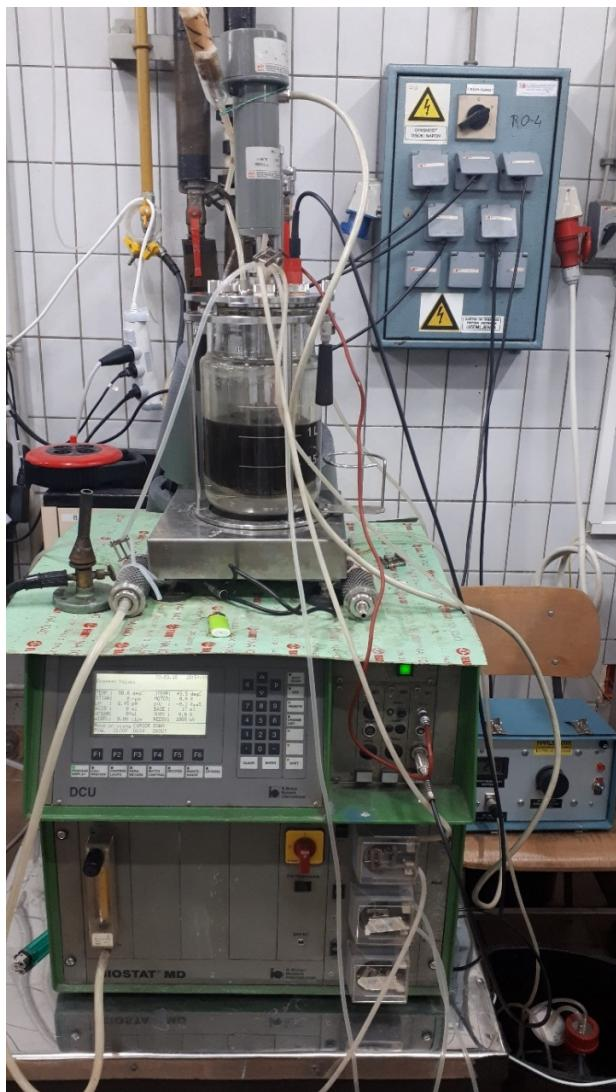
**Slika 5.** Bioreaktor s miješalom Biostat MD (izvor: vlastita fotografija)
