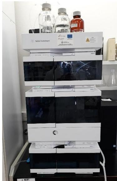
**Slika 3.** Uređaj za tekućinsku kromatografiju ultra djelotvornosti (UPLC) (izvor: vlastita fotografija)
