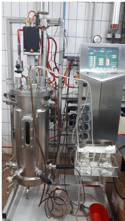
**Slika 4.** Bioreaktor s miješalom Biostat Cplus (izvor: vlastita fotografija)
