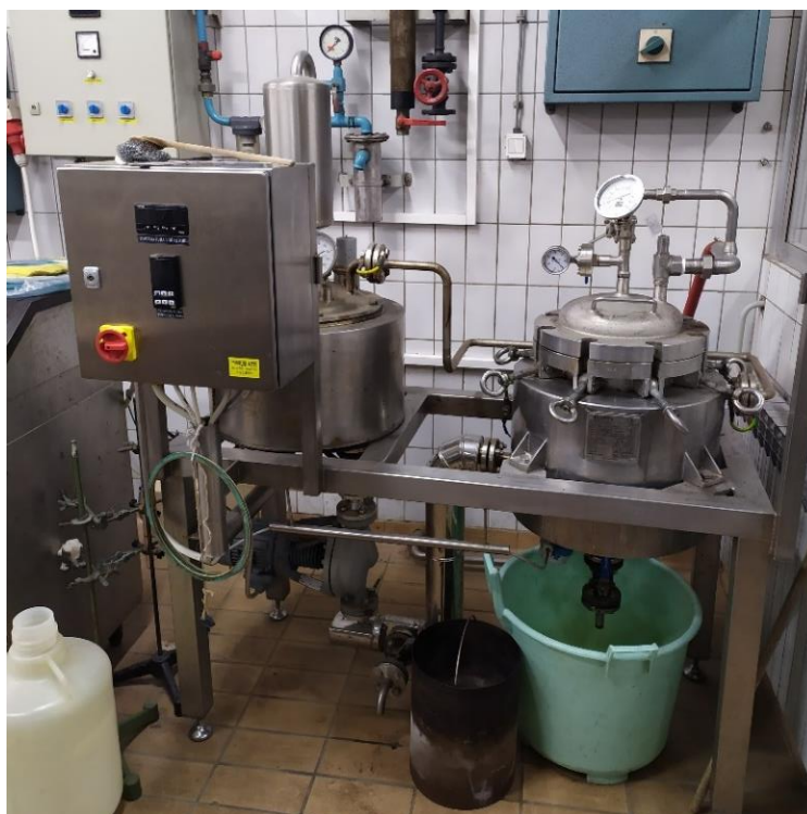
Slika 4. Visokotlačni reaktor za obradu lignoceluloznih sirovina ( vlastita fotografija )
