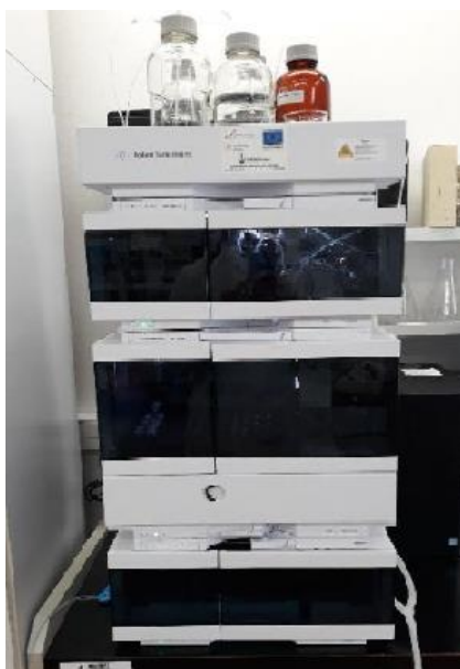
Slika 3. Uređaj za tekućinsku kromatografiju ultra visoke djelotvornosti (UPLC Agilent Technologies 1290 Infinity II) ( vlastita fotografija )
