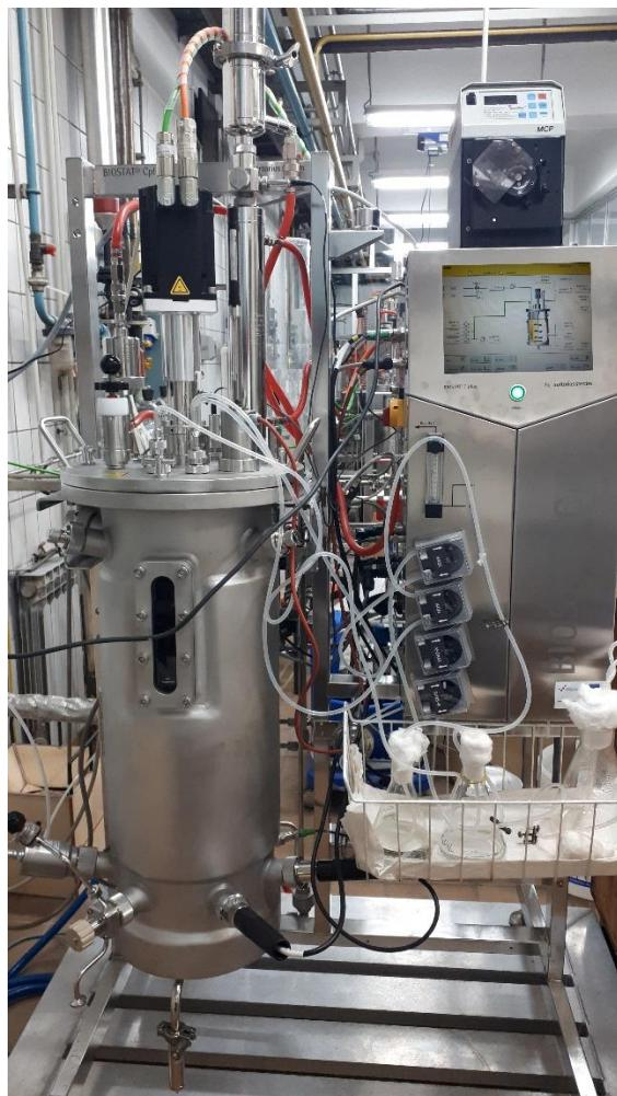
**Slika 5.** Bioreaktor s miješalom Biostat Cplus (Sartorius BBI Systems GmbH, Njemačka)
