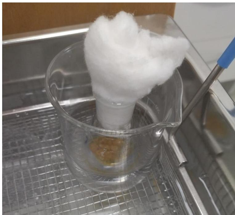
**Slika 10.** Ekstrakcija u ultrazvučnoj kupelji (Vlastita fotografija)
