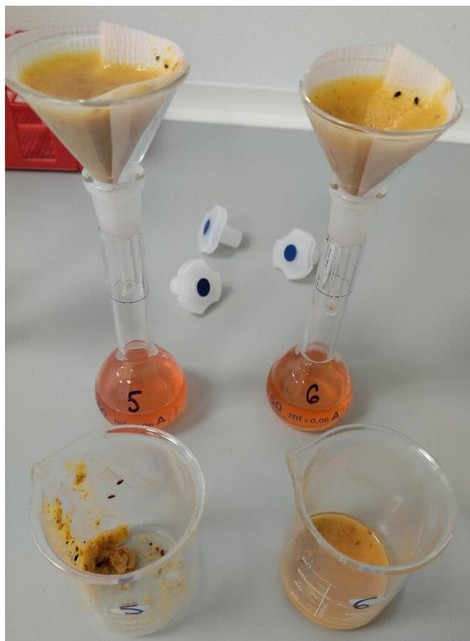
**Slika 9.** Filtracija ekstrakata po provedenoj ultrazvučnoj ekstrakciji (Vlastita fotografija)
