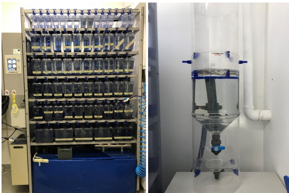
Slika 6. a) ZebTEC samoregulirajući sustav za uzgoj zebrića s Active Blue tehnologijom (Tecniplast S.p.A.) unutar kojeg se odvija uzgoj i održavanje zebrića (lijevo) i b) Mrijestilica iSpawn-S Benchtop Size Breeding System (Tecniplast S.p.A.) koja se koristila za mrijest zebrića ( vlastita fotografija )
