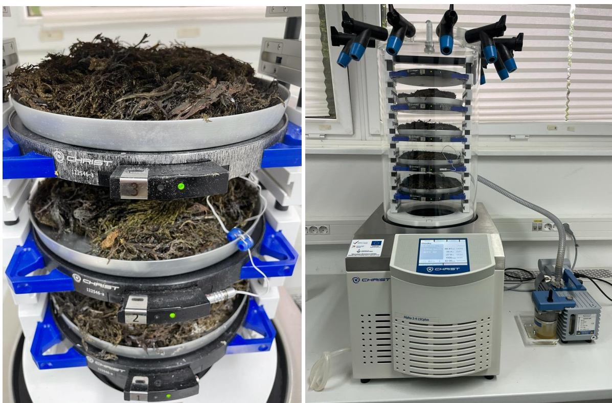
Slika 5. a) Alga Cystoseira compressa unutar liofilizatora (lijevo) i b) Martin Christ Alpha 2-4 LSCplus liofilizator (desno) (vlastita fotografija)
