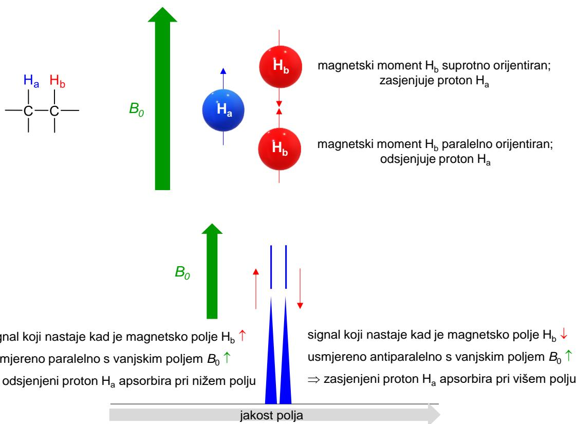
Slika 74. Cijepanje signala spregom spinova.
