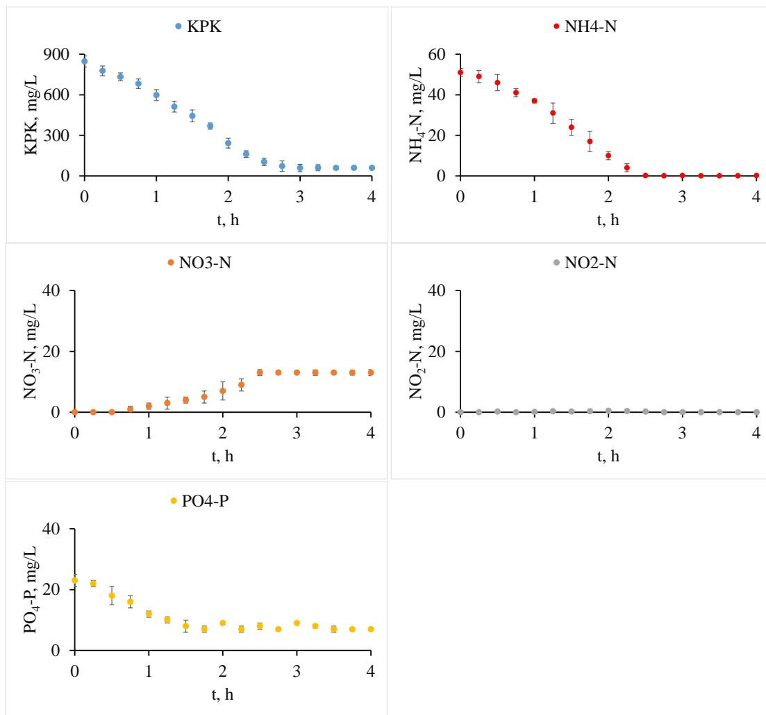
Slika 14. Promjene KPK, NH<sub>4</sub>-N, NO<sub>3</sub>-N, NO<sub>2</sub>-N i PO<sub>4</sub>-P u šaržnom pokusu pri KPK/N 17, u anoksično/aerobnom procesu, pri čemu je 5 min anoksično punjenje
