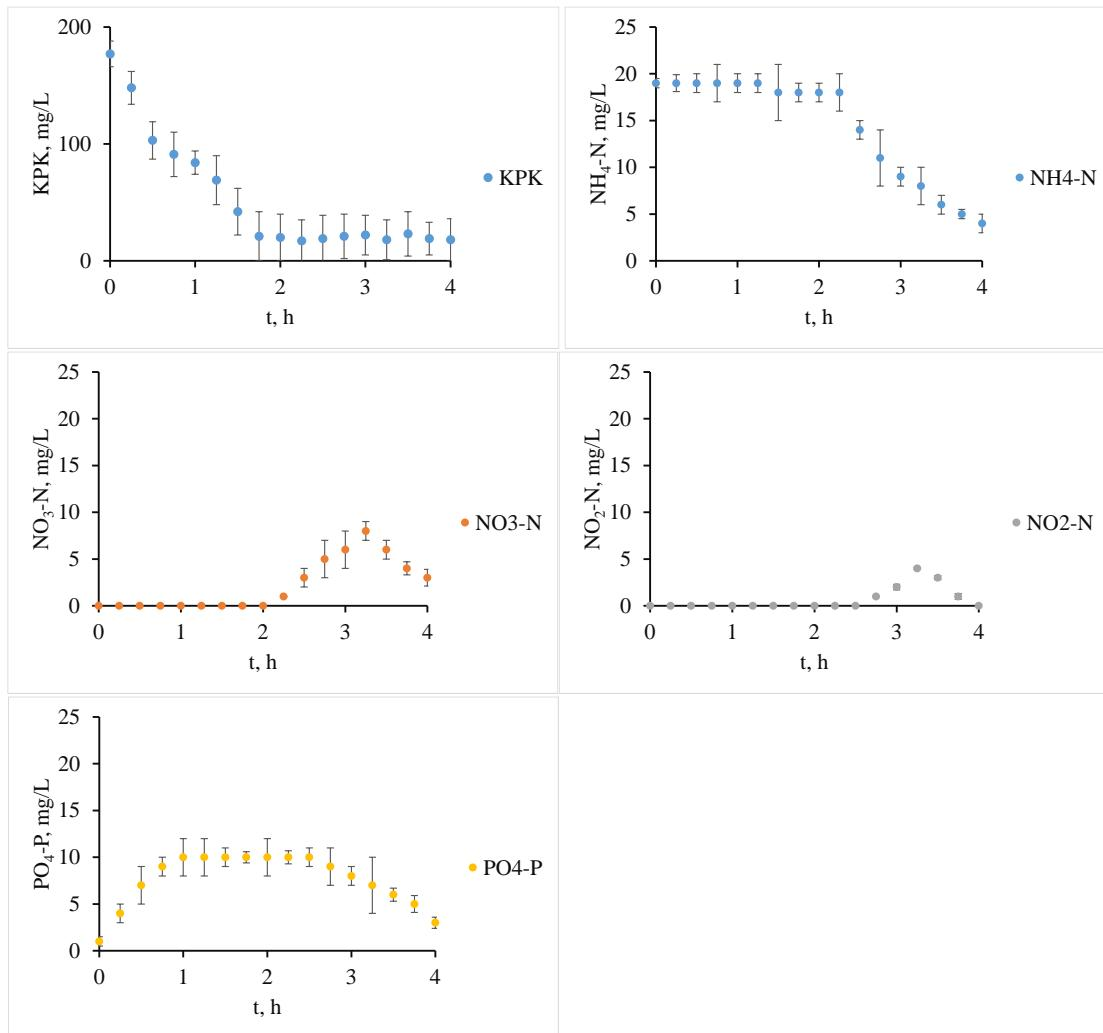
Slika 29. Promjene KPK, NH<sub>4</sub>-N, NO<sub>3</sub>-N, NO<sub>2</sub>-N i PO<sub>4</sub>-P u anoksično/aerobnom procesu pri niskoj koncentraciji otopljenog kisika u aerobnoj fazi procesa, pri KPK/N
