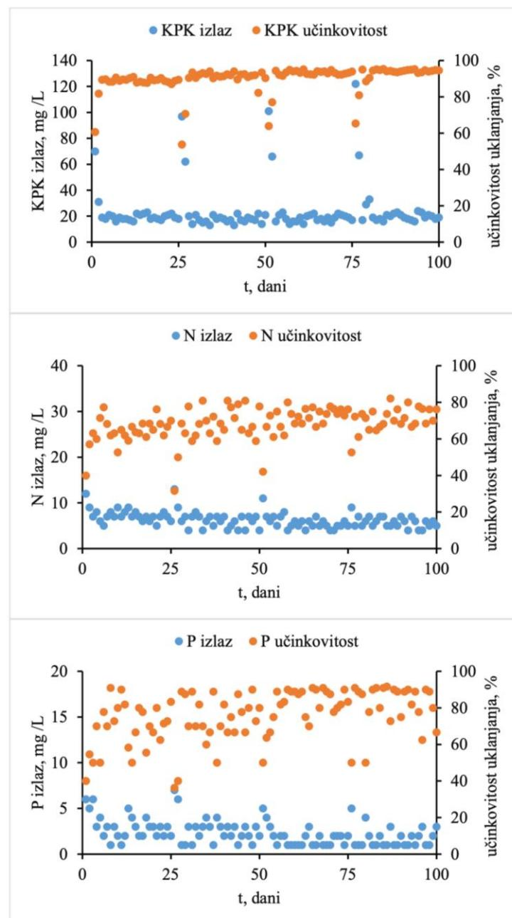
Slika 28. Izlazne vrijednosti i učinkovitost uklanjanja KPK, N i P tijekom anaerobno-aerobnog procesa pri  $\text{DO} < 1 \text{ mg/L}$  u aerobnoj fazi procesa
