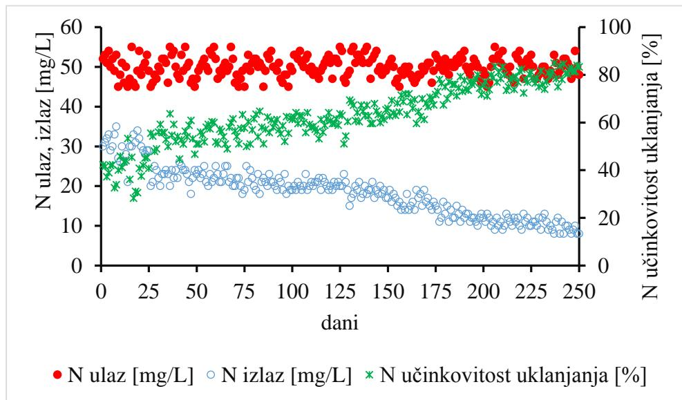
Slika 11. Promjene koncentracije N u ulazu, izlazu i učinkovitost uklanjanja N pri omjerima KPK/N 1-23.
