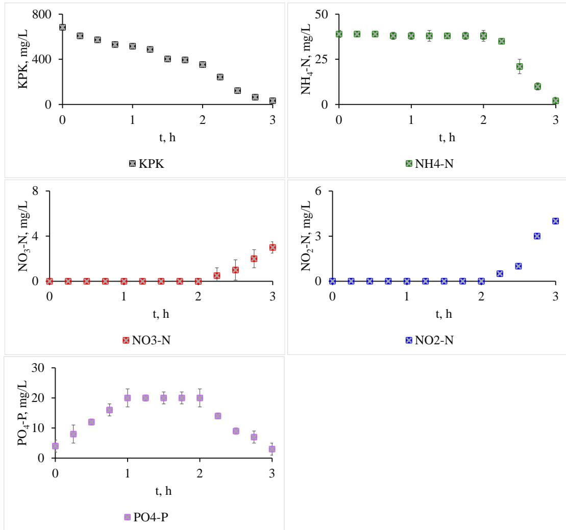
Slika 27. Promjene KPK, NH<sub>4</sub>-N, NO<sub>3</sub>-N, NO<sub>2</sub>-N i PO<sub>4</sub>-P pri omjeru C/N 9 u anoksično/aerobnom režimu
