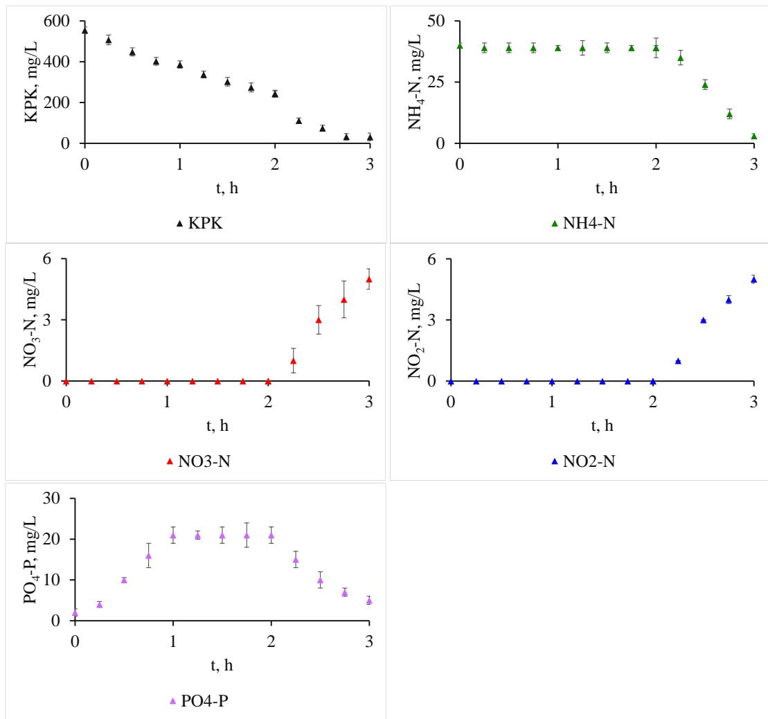
Slika 26. Promjene KPK, NH<sub>4</sub>-N, NO<sub>3</sub>-N, NO<sub>2</sub>-N i PO<sub>4</sub>-P pri omjeru C/N 7 u anoksično/aerobnom režimu
