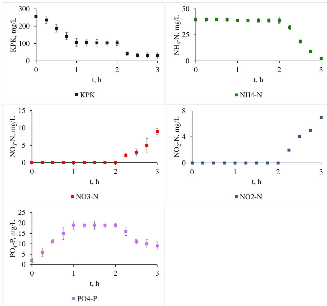
Slika 24. Promjene KPK, NH<sub>4</sub>-N, NO<sub>3</sub>-N, NO<sub>2</sub>-N i PO<sub>4</sub>-P pri omjeru C/N 3 u anoksično/aerobnom režimu
