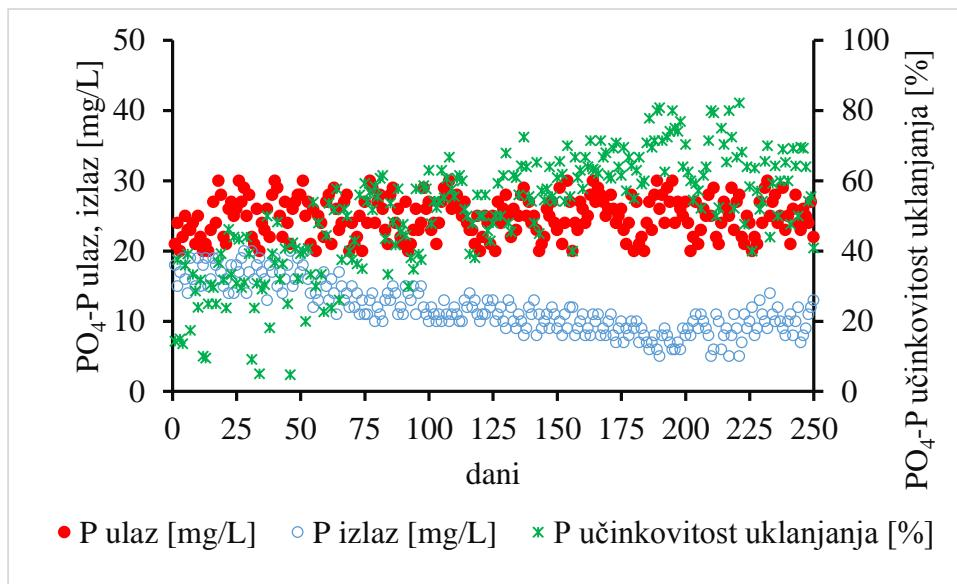
Slika 12. Promjene koncentracije PO<sub>4</sub>-P u ulazu, izlazu i učinkovitost uklanjanja PO<sub>4</sub>-P pri omjerima KPK/N 1-23.
