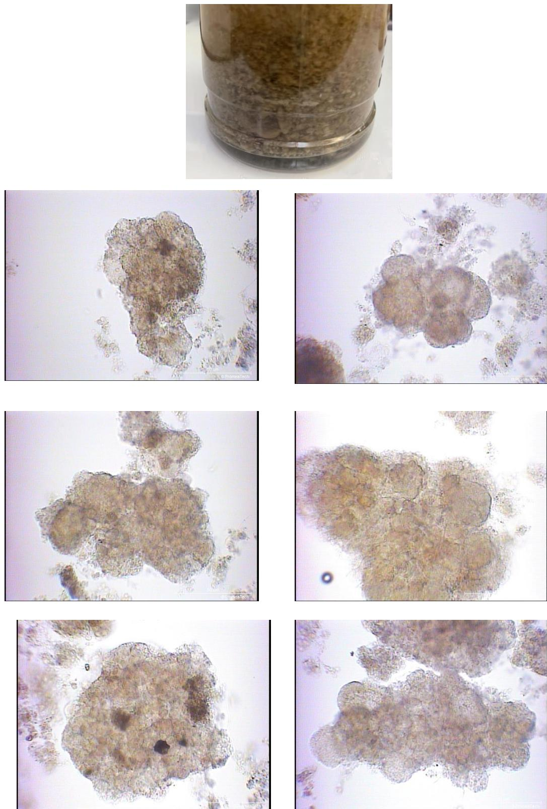
Slika 9. Aerobni granulirani mulj – izgled, i mikroskopska slika aerobnih granula, tijekom formiranja AGS (svjetlosni mikroskop, povećanje 640 x)
