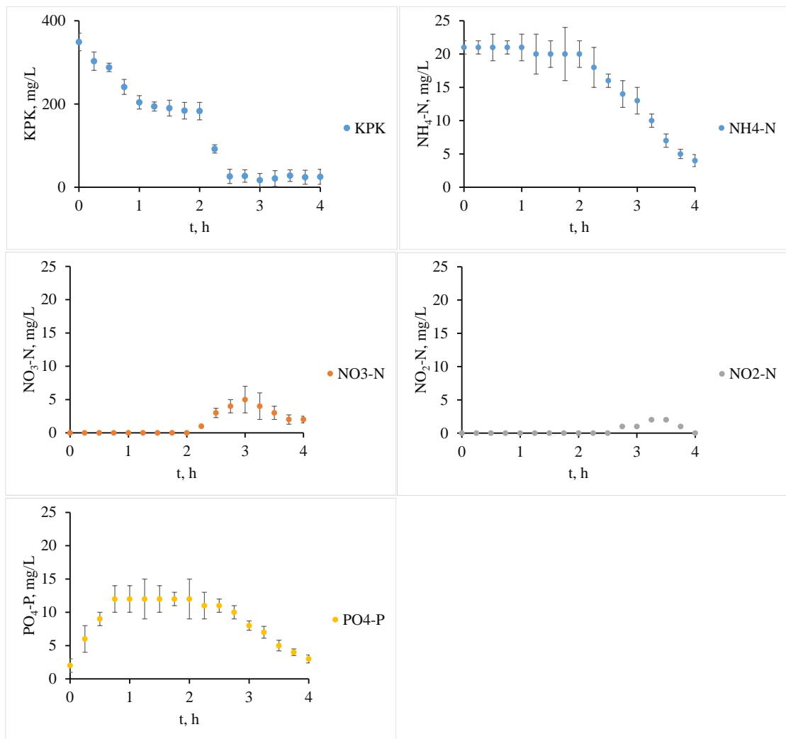
Slika 32. Promjene KPK, NH<sub>4</sub>-N, NO<sub>3</sub>-N, NO<sub>2</sub>-N i PO<sub>4</sub>-P u anoksično/aerobnom procesu pri niskoj koncentraciji otopljenog kisika u aerobnoj fazi procesa, pri KPK/N 17
