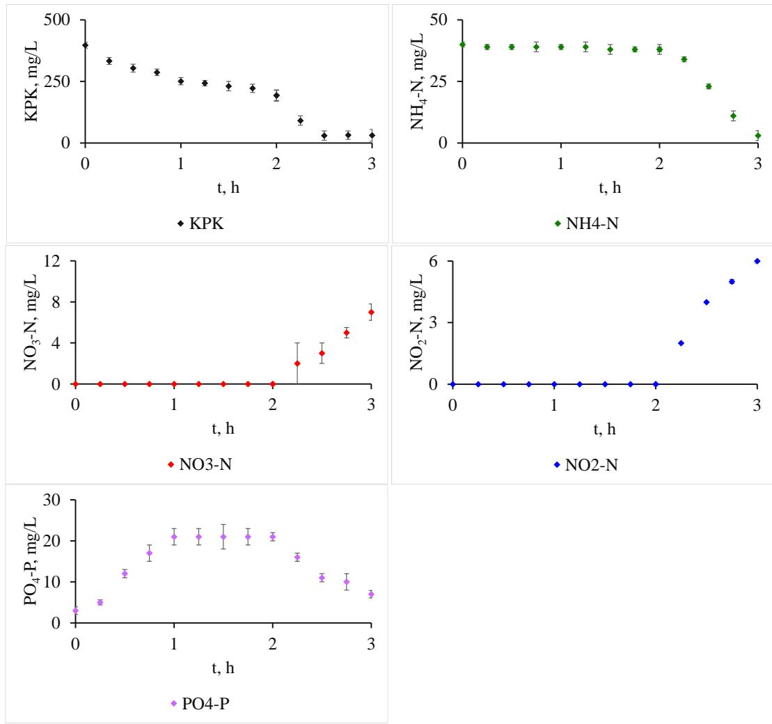
Slika 25. Promjene KPK, NH<sub>4</sub>-N, NO<sub>3</sub>-N, NO<sub>2</sub>-N i PO<sub>4</sub>-P pri omjeru C/N 5 u anoksično/aerobnom režimu
