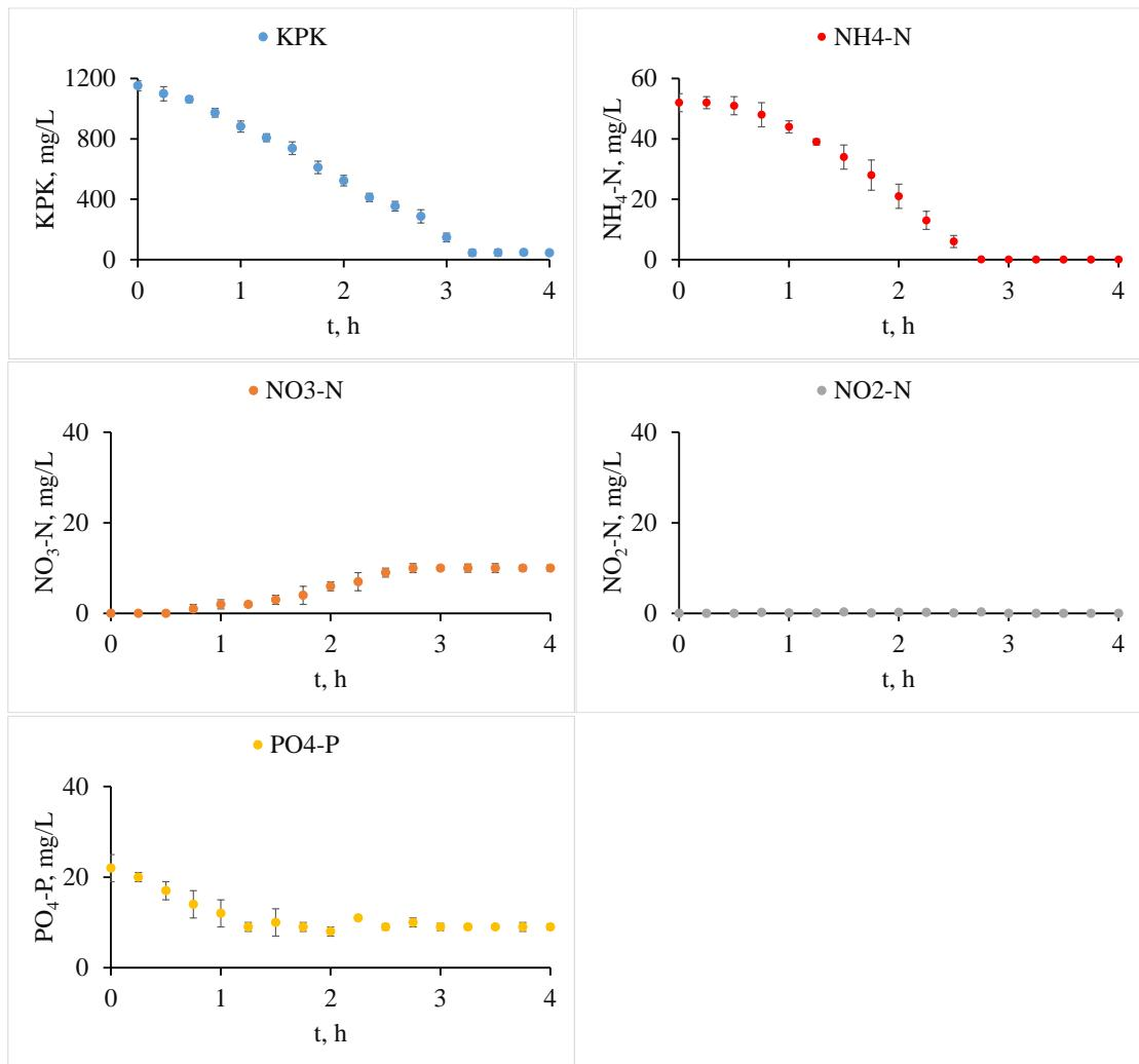
Slika 15. Promjene KPK, NH<sub>4</sub>-N, NO<sub>3</sub>-N, NO<sub>2</sub>-N i PO<sub>4</sub>-P u šaržnom pokusu pri KPK/N 23, u anoksično/aerobnom procesu, pri čemu je 5 min anoksično punjenje
