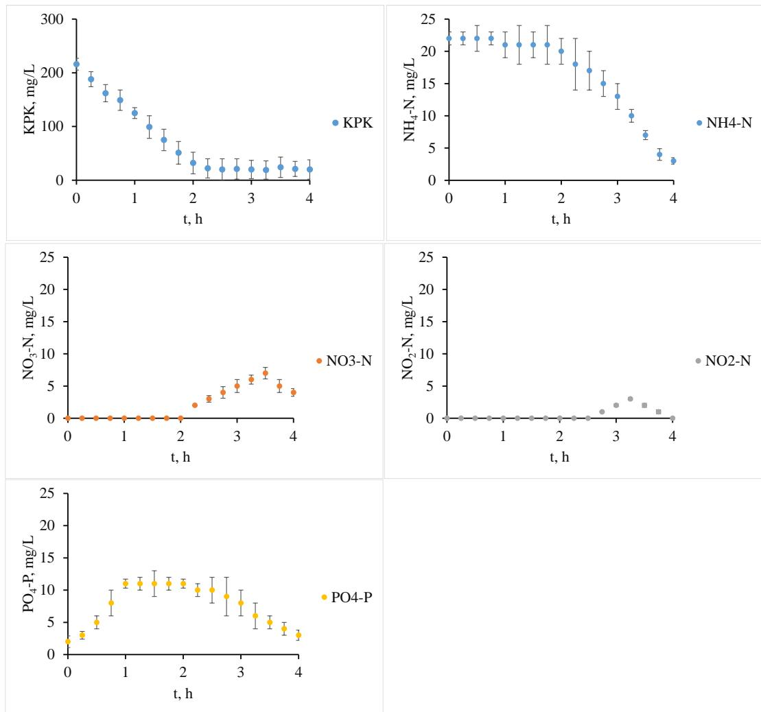
Slika 30. Promjene KPK, NH<sub>4</sub>-N, NO<sub>3</sub>-N, NO<sub>2</sub>-N i PO<sub>4</sub>-P u anoksično/aerobnom procesu pri niskoj koncentraciji otopljenog kisika u aerobnoj fazi procesa, pri KPK/N
