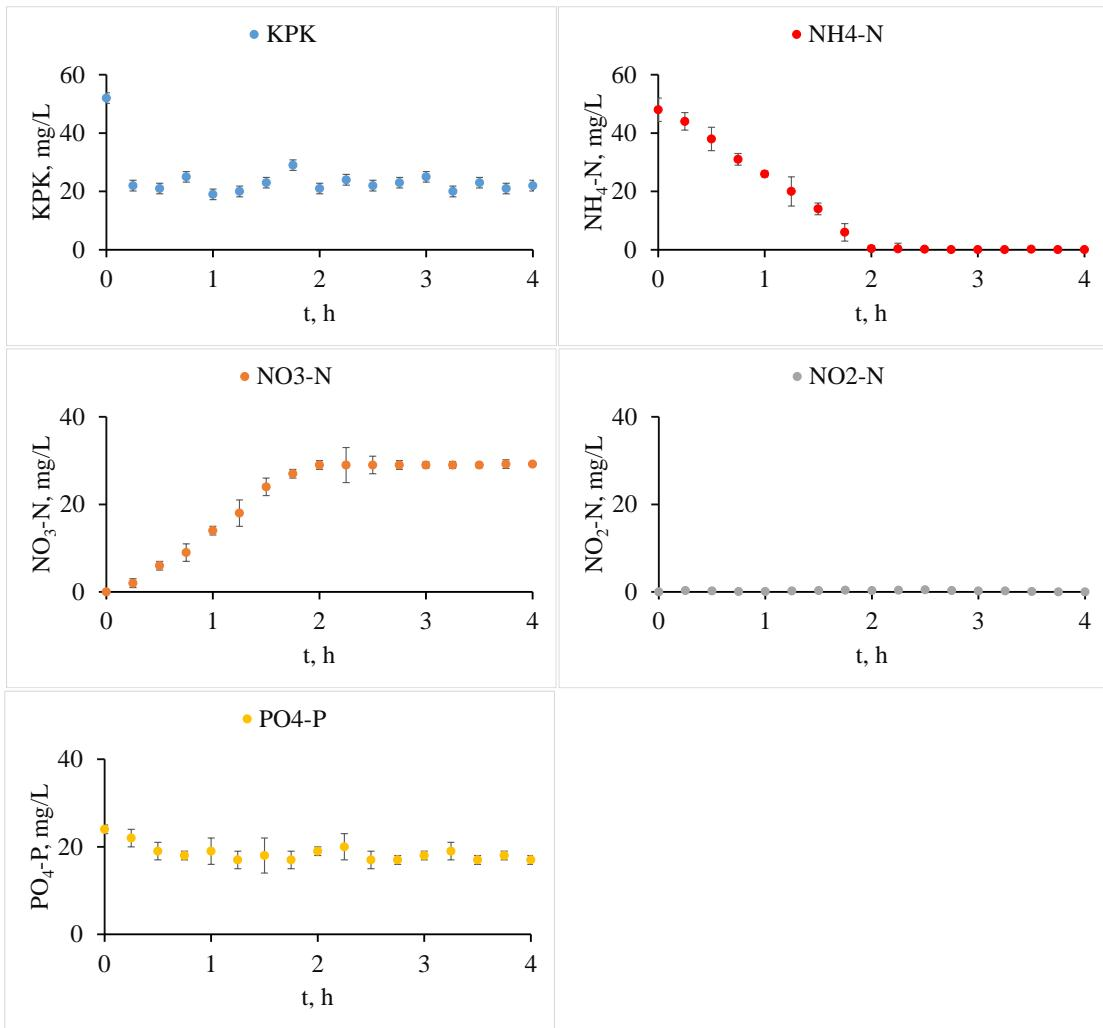
Slika 13. Promjene KPK, NH<sub>4</sub>-N, NO<sub>3</sub>-N, NO<sub>2</sub>-N i PO<sub>4</sub>-P u šaržnom pokusu pri KPK/N 1, u anoksično/aerobnom procesu, pri čemu je 5 min anoksično punjenje
