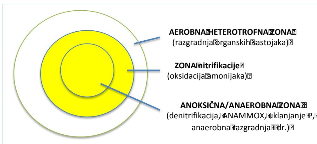
Slika 1. Slojevita struktura granule (preuzeto i prilagođeno iz Sharma i sur., 2019)
