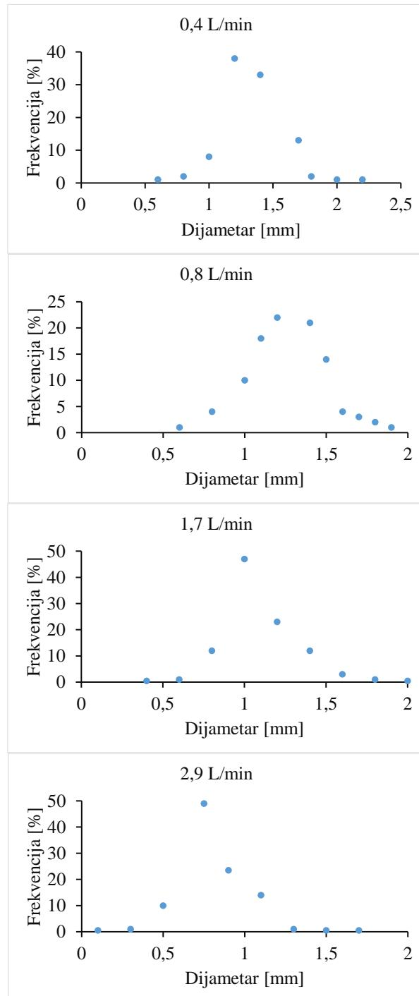
Slika 17. Veličina i zastupljenost granula pri protoku zraka 0,4 L/min, 0,8 L/min, 1,7 L/min i 2,9 L/min
