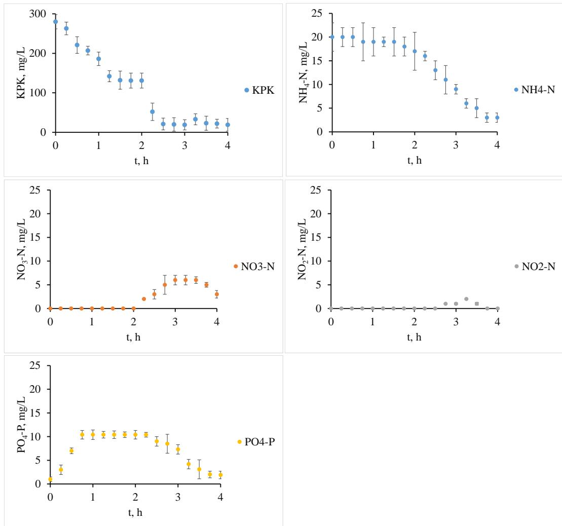
Slika 31. Promjene KPK, NH<sub>4</sub>-N, NO<sub>3</sub>-N, NO<sub>2</sub>-N i PO<sub>4</sub>-P u anoksično/aerobnom procesu pri niskoj koncentraciji otopljenog kisika u aerobnoj fazi procesa, pri KPK/N
