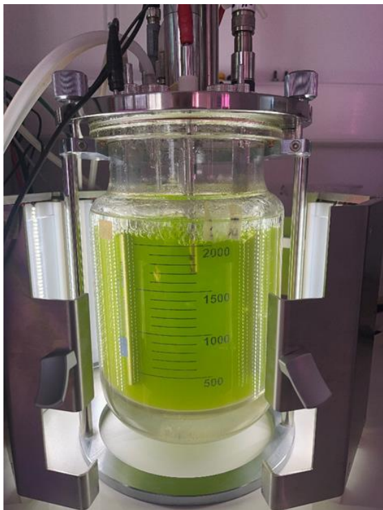
Slika 4. Uzgoj mikroalge D. tertiolecta u laboratorijskom fotobioreaktoru u a) kontrolnoj hranjivoj podlozi i b) hranjivoj podlozi obogaćenoj sa 20,00 mg L^{-1} selenita (vlastite fotografije).
