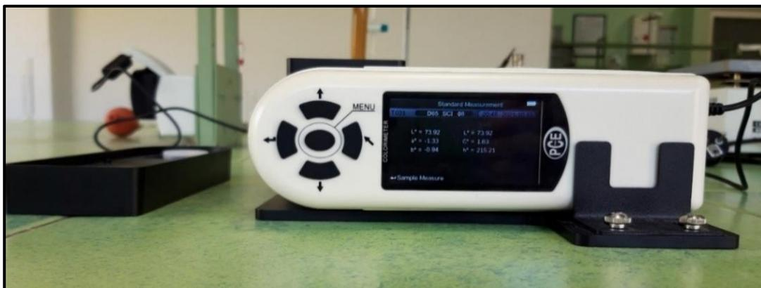
**Slika 4.** Kolorimetar PCE-CSM 3 (vlastita fotografija)
