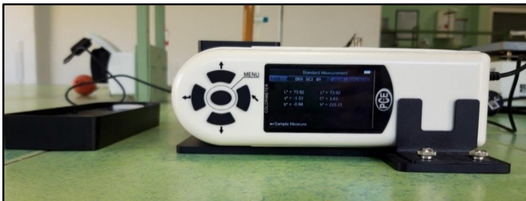
Slika 4. Kolorimetar PCE-CSM 3 (vlastita fotografija)
