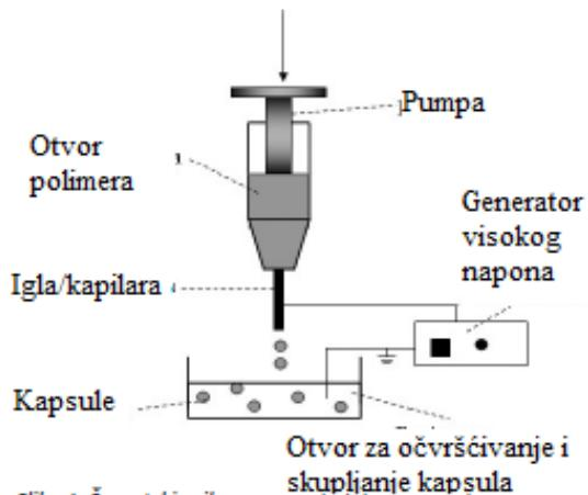
**Slika 5.** Shematski prikaz osnovnih dijelova aparature za izvođenje elektrostatske ekstruzije
