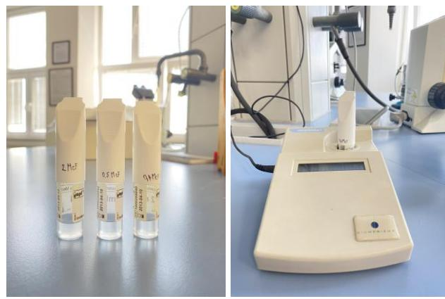
**Slika 5.** Priprema (a) i mjerjenje McFarland jedinica (b) (vlastita fotografija)
