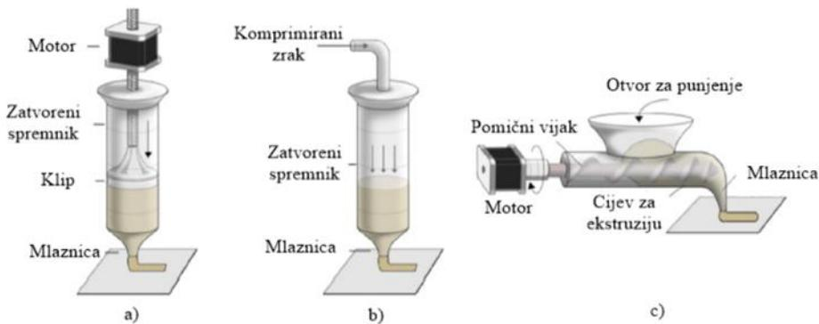
Slika 1. Mehanizmi ekstruzije u 3D tiskanju hrane (Sun i sur., 2017.; prijevod Grgić, 2020.)
