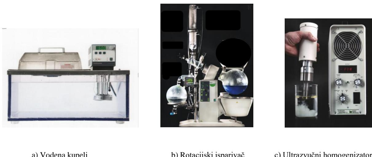
a) Vodena kupelj                        b) Rotacijski isparivač                        c) Ultrazvučni homogenizator
