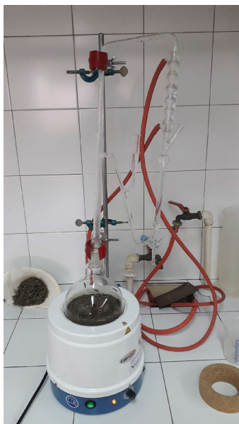
Slika 1. Aparatura za vodenu destilaciju po Clevengeru (vlastita fotografija)
