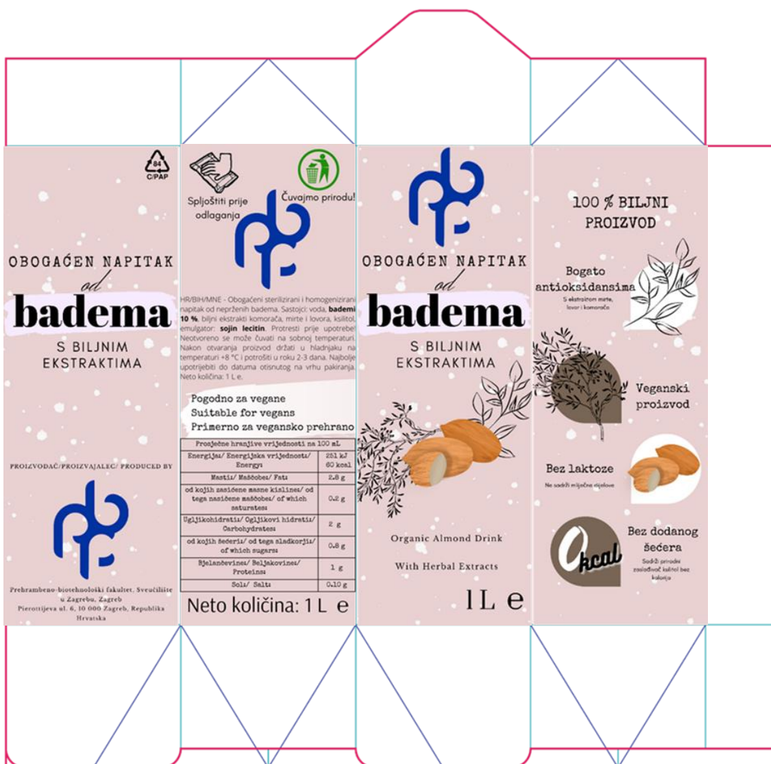
Slika 15. Primjer primarne ambalaže (73 × 73 × 200 mm) u koju se pakira obogaćen bademov napitak (vlastiti crtež)
