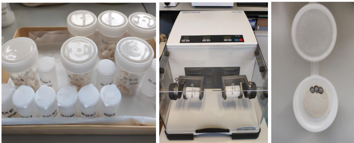
Slika 4. S lijeva na desno: posudice s uzorcima nakon liofilizacije, uređaj za homogenizaciju (MM 400 Retsch, Njemačka), homogenat ribljeg mišićja u posudici s volframovim kuglicama
