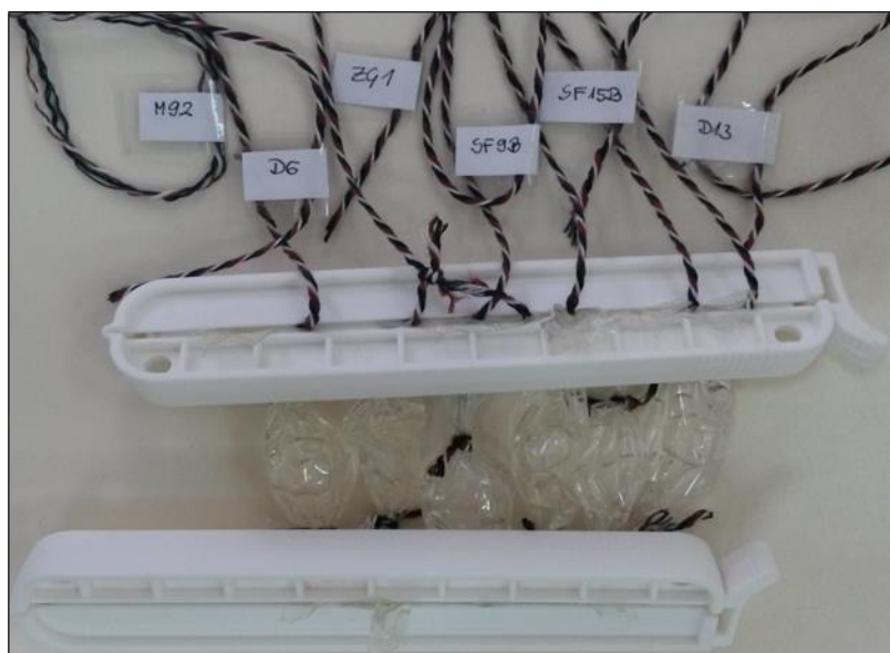
Slika 5. Prikaz pripremljenih ispitivanih uzoraka prije dijalize koji se nalaze u Spectra/Por poroznoj membrani pričvršćeni na krajevima vezicom
