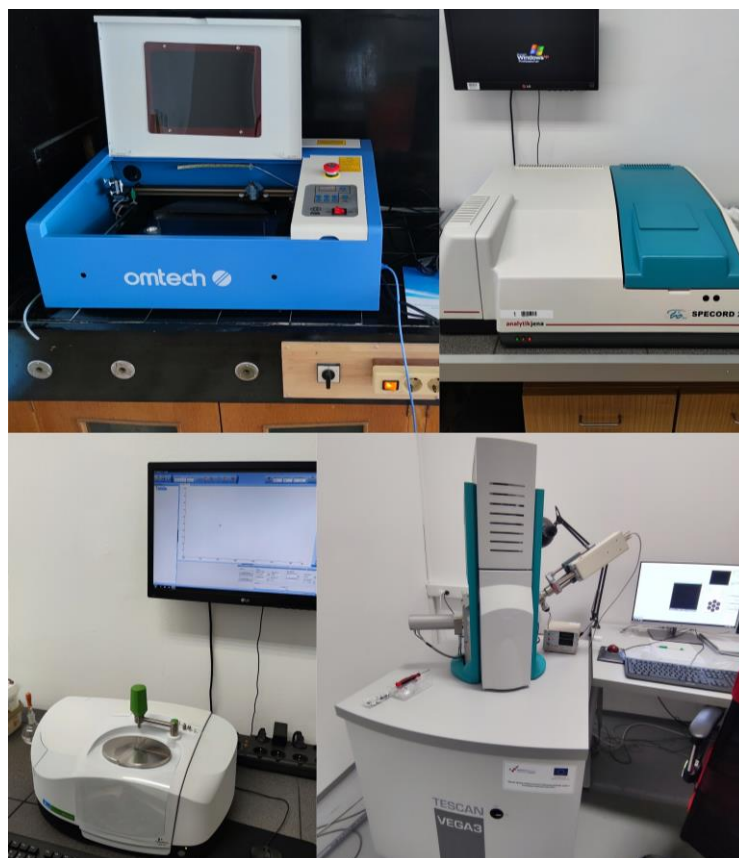
Slika 5. Laboratorijska instrumentacija korištena u radu. S lijeva na desno, prvi red: CO 2 laser OmTech 40 W i spektrofotometar Specord 200, Analytik Jena. S lijeva na desno, drugi red: FTIR spektrometar SpectrumTwo, Perkin Elmer i SEM Tescan Vega 3.
