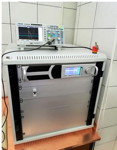
Slika 3. HVED i plazma generator IMP-SSPG-1200 (Impel grupa, Zagreb, Hrvatska)
