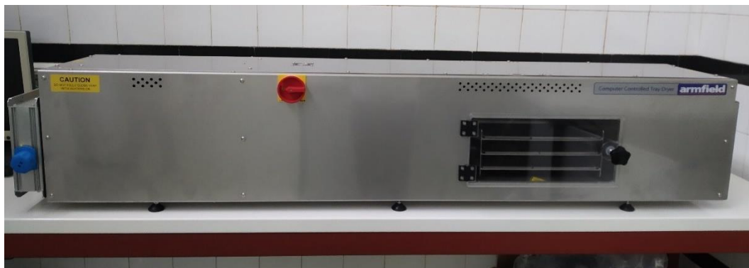
Slika 7. Konvekcijska sušara (ARMFIELD UOP8- MKII, Ringwood, England) vlastita fotografija)
