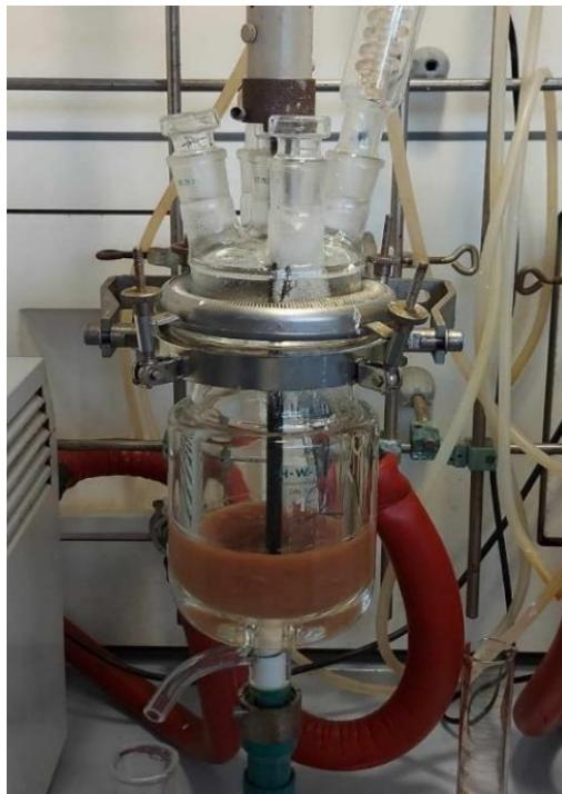
**Slika 3.** HWS stakleni 1 L reaktor s dvostrukim plaštom i ispustom na dnu
