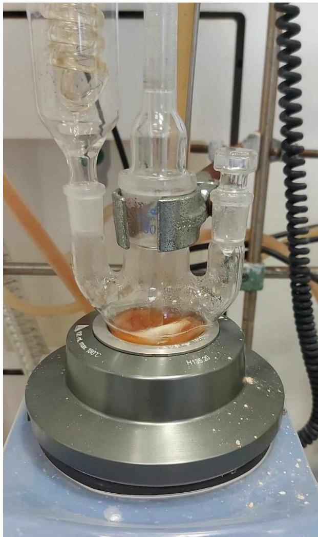
**Slika 4.** Sinteza onečišćenja RRT 1,37 u trogrloj tirkici od 0,5 L (vlastita fotografija, 2023)
