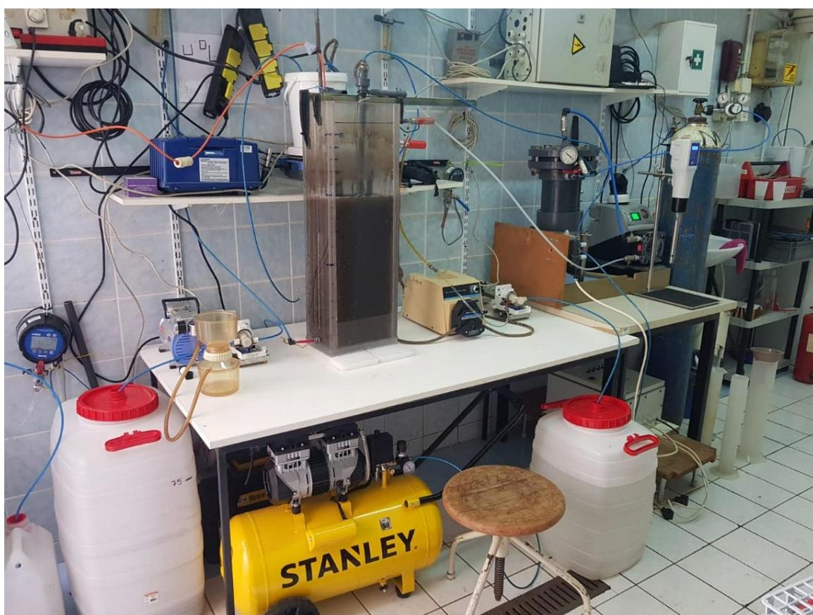
**Slika 15.** Laboratorijski MBR uređaj (vlastita fotografija)
