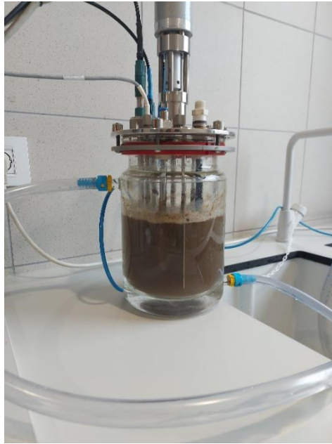
Slika 14. Bioreaktor tvrtke “Applikon” za određivanje biološke aktivnosti PAO-a (vlastita fotografija)
