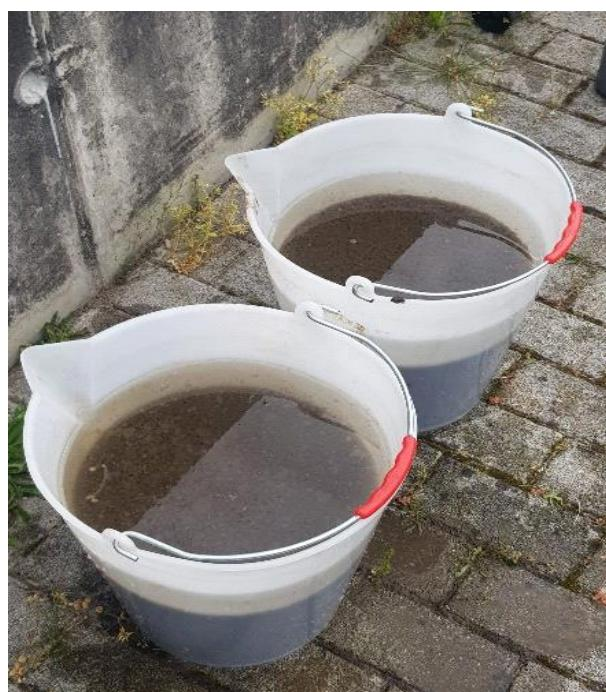
**Slika 16.- Aktivni mulj iz bioaeracijskog bazena (vlastita fotografija)**
