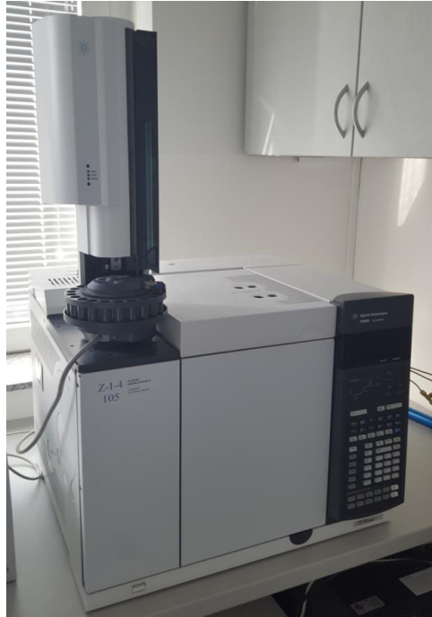
Slika 18 Plinski kromatograf (GC) s plameno-ionizacijskim detektorom (FID)
