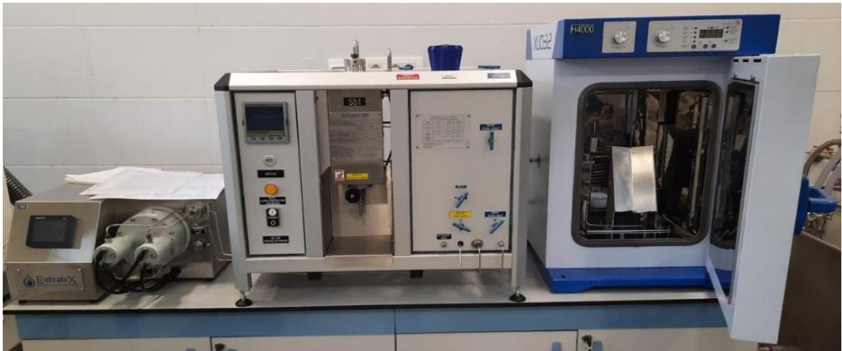
**Slika 5.** Uređaj za ekstrakciju superkritičnim CO<sub>2</sub> (*vlastita fotografija*)
