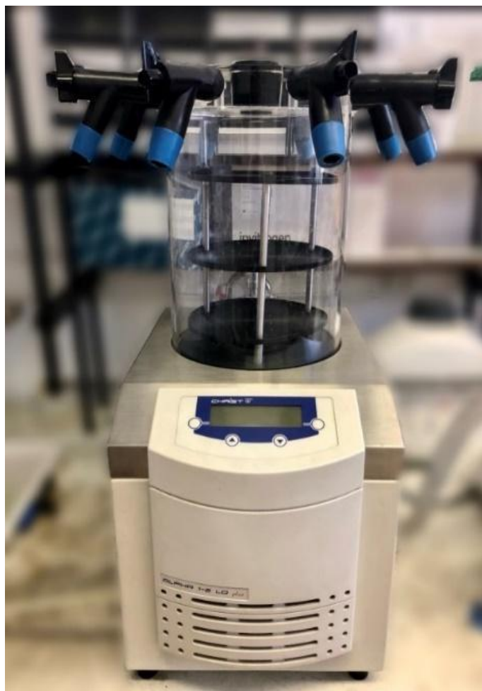
Slika 4. Liofilizator Christ Alpha 1-2 LD plus ( vlastita fotografija )
