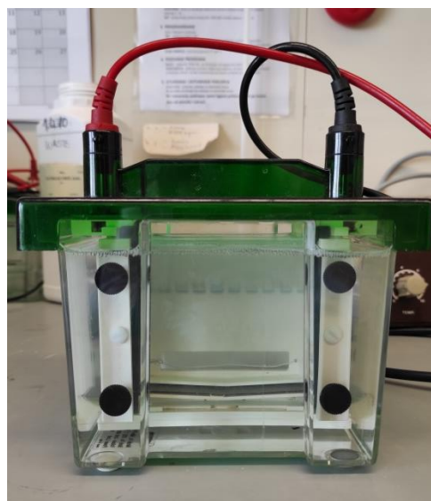
Slika 5. Prikaz SDS-PAGE elektroforeze (vlastita fotografija)
